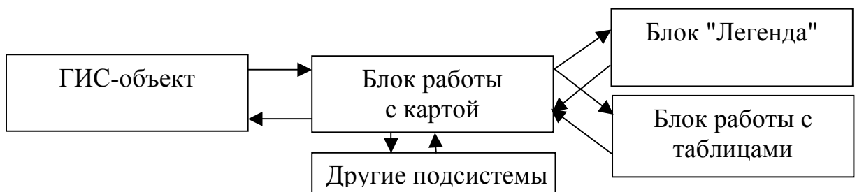
Рис. 3.8. Схема подсистемы взаимодействия с ГИС-компонентой
